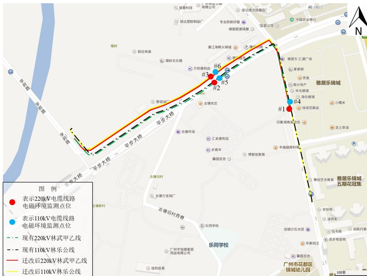
图 11 220kV 林武甲乙线、110kV 林乐公线电磁环境现状监测布点示意图
